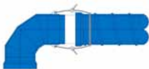
Sammenføring af rør med momenttaljer.
